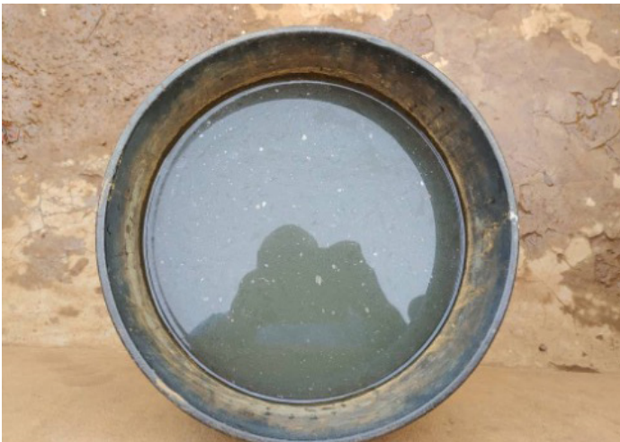
Planche 15-Mauvaise qualité de l'eau du forage avec la formation d'une plaque grisante
