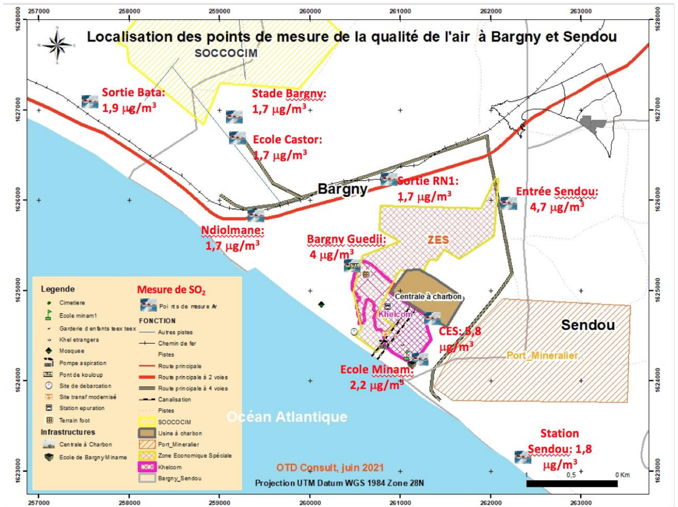
Carte 5 : Répartition spatiale de la pollution par les SO 2 (Tosyali se trouve dans la ZES)
