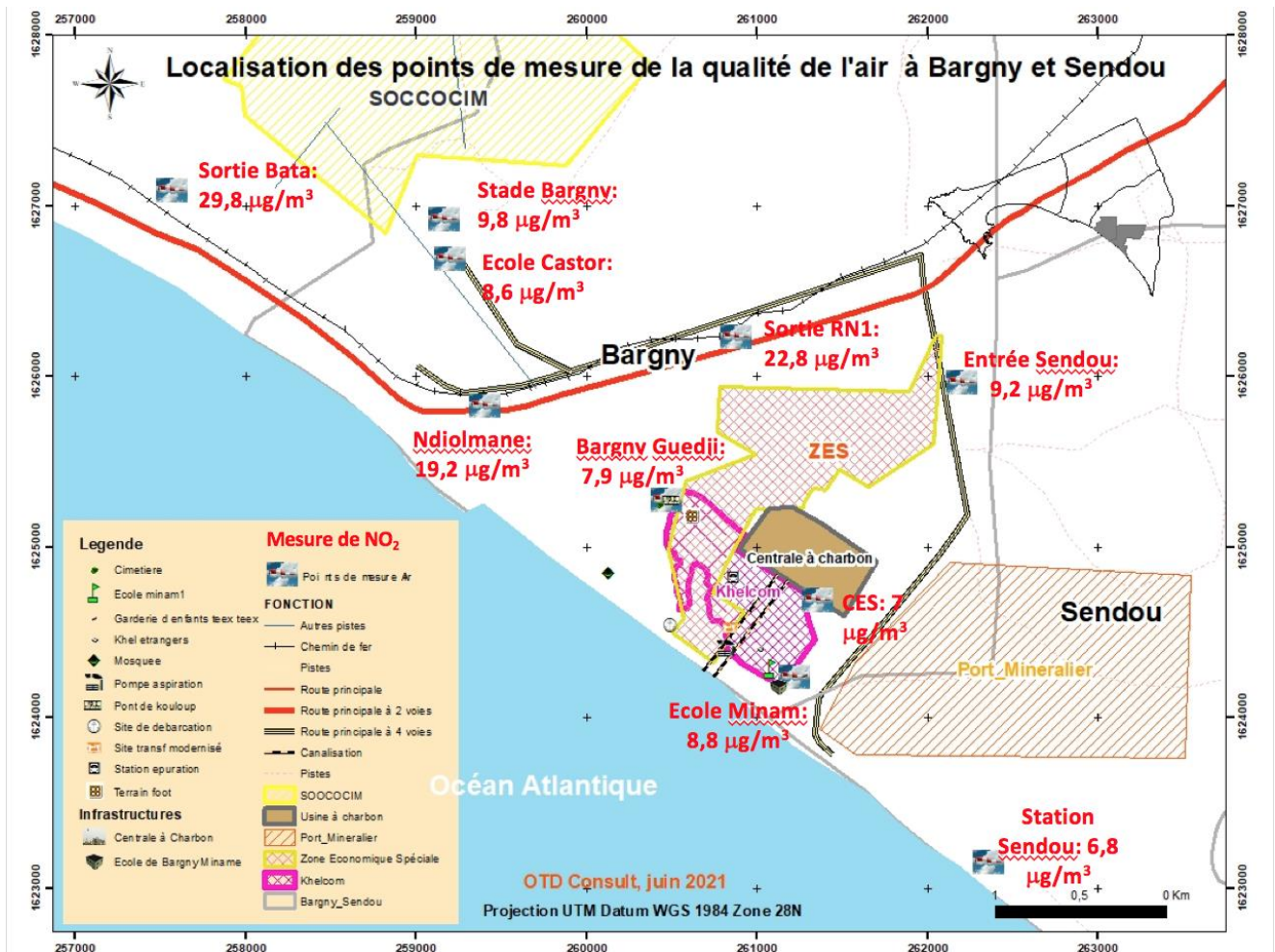
Carte 6 : Répartition spatiale de la pollution par les NO 2 (Tosyali se trouve dans la ZES)
